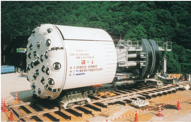
写真-1 TBM外形
