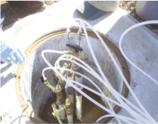
窒素ガス圧送による採水(4区間同時に実施している事例)
