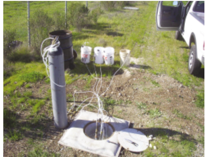
窒素ガス圧送による採水(4区間同時に実施している事例)
