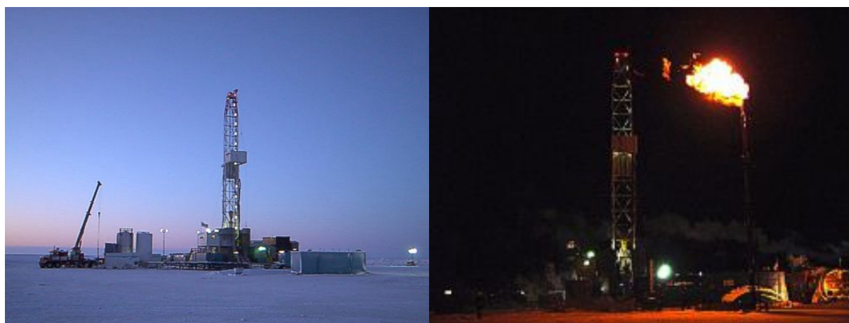
図-8 マリック生産試験井、(左) 厳寒の地の試験井(Mallik 5L-38)、 (右) 生産試験により噴出したメタンガスの炎。
