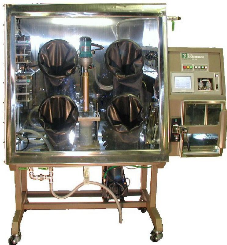
写真3 グローブボックスに収められたコアリング装置。嫌気状態で岩石コアの芯を抜き出すもので、この岩芯の中に潜んでいる地下微生物だけを取り出すことができる。
