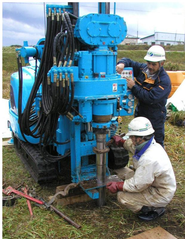
写真 2 海岸近くで実施した深度 100m のコアボーリング。深度 80m までは、砂、シルト、粘土などの互層であった。コアから、作孔水などで汚染されていない間隙水を採取するために、特殊な掘削装置(高周波バイブロ・低速回転, コアパック装着・ワイヤーライン方式)を用い無水で掘削した。コアの回収率はよかった。
