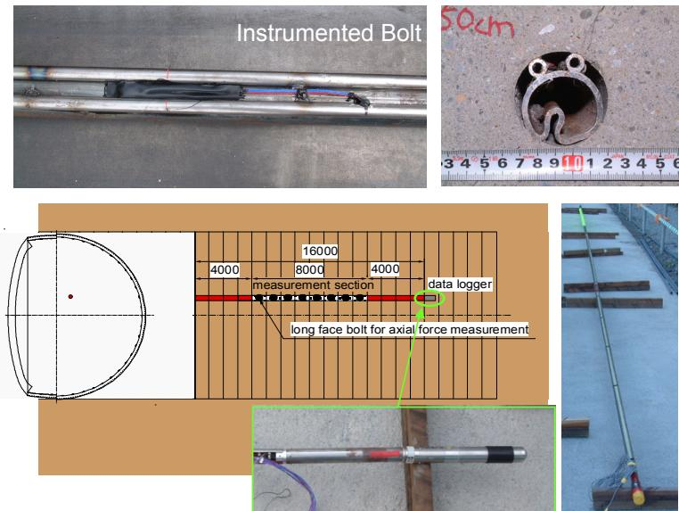
切羽に打設したボルトに発生する軸力分布を測定し、長尺鏡止めボルトの補強効果を検証します。連結式鋼管膨張型ボルトの軸力計を新たに開発し、トンネル切羽に打設した長尺鏡止めボルトに発生した軸力分布変化を計測しました。
