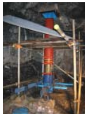
写真-1 平板載荷試験状況
