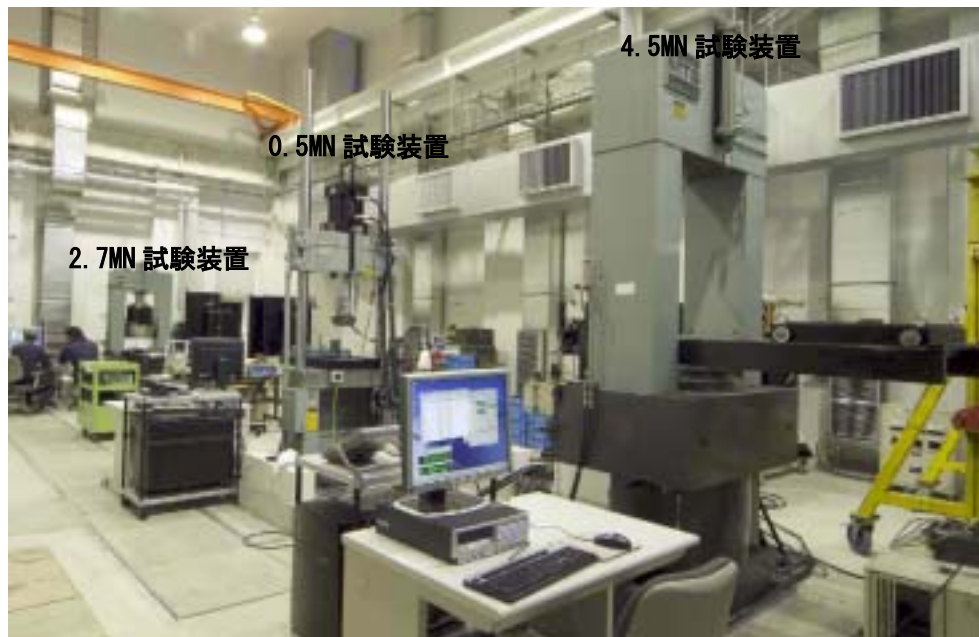
写真-2 岩石試験室と高剛性三軸試験装置状況
