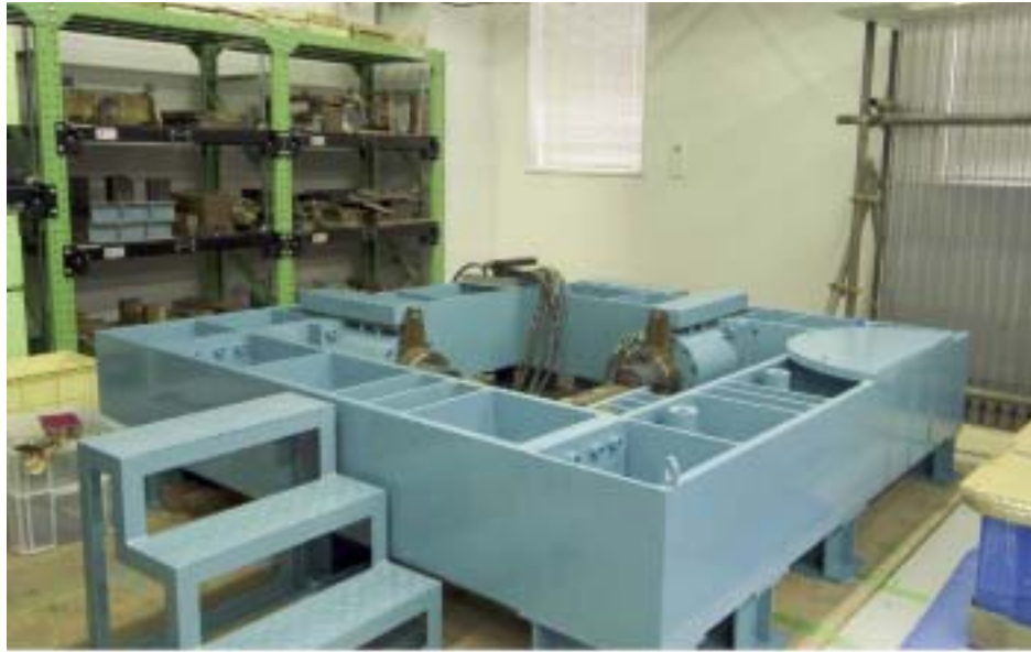
写真-5 多目的実験室の大型せん断装置の設置状況
