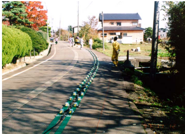
図4.1 ランドストリーマ探査状況写真 1)
