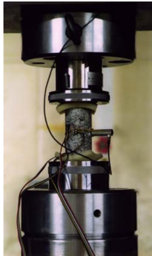
図3.2 AEによる初期地圧測定状況
