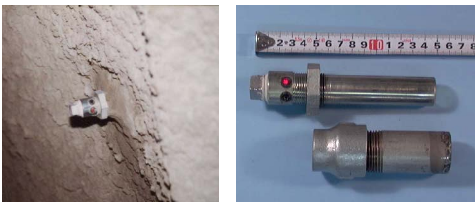
図2.3 トンネル計測専用ターゲット
