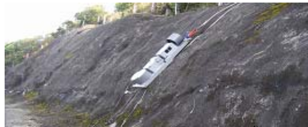
図6.20 FDEM探査の測定状況 4)
