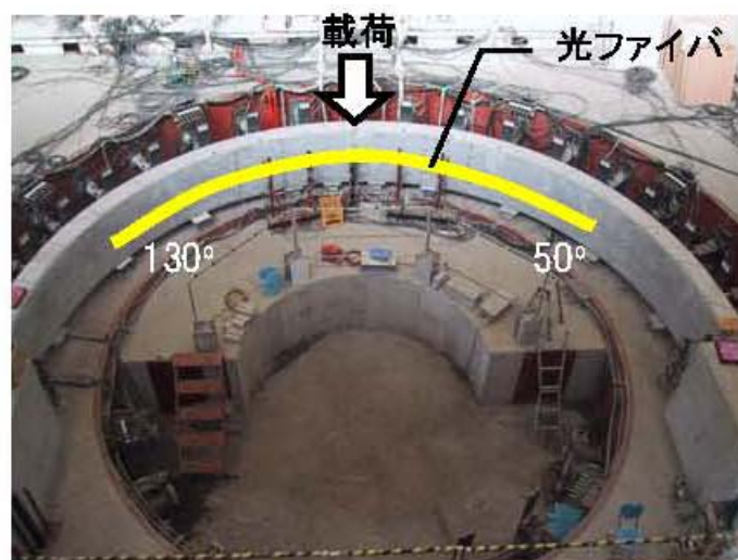
写真2.2 トンネル覆工コンクリート試験体
