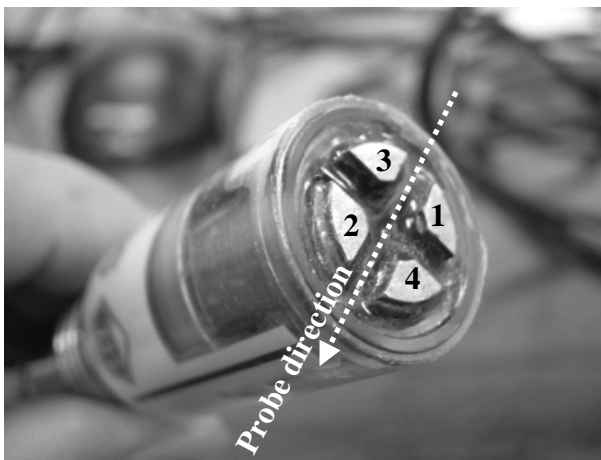
図2.12 磁歪センサ（直径20 mm程度）
