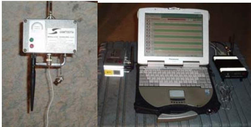
図4.10 無線式TRT探査システムの構成機器 (左：無線送信器，右：記録コンピュータ)
