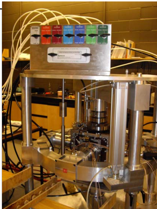
図 7.11 三軸チャンバーの内部構造（左）とチャンバー内の内部構造（右）
