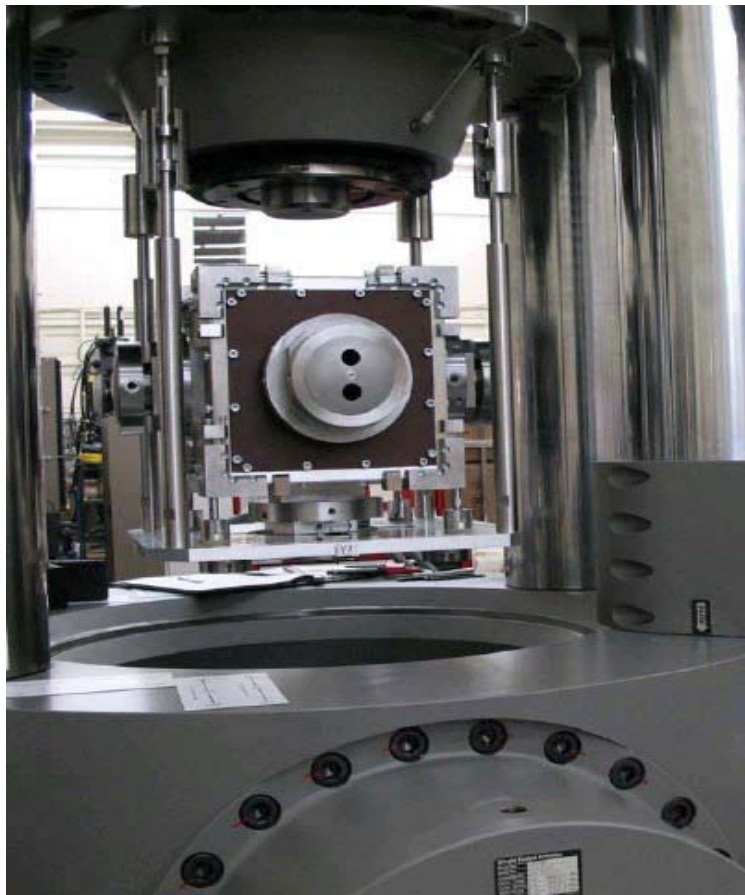
図 7.12 真三軸試験装置に設置するジオフィジカル・イメージングセル
