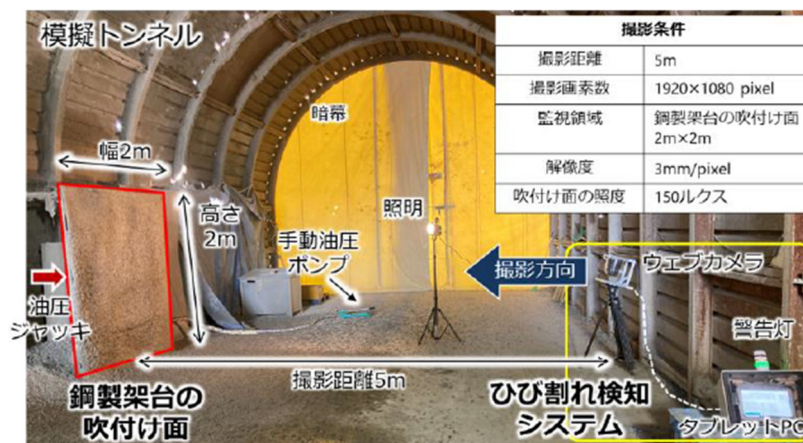
図 模擬トンネル内の機器の配置
